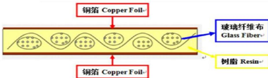
半固化片通常由玻璃纤维布（又称玻纤布）作为增强材料，在玻纤布表面均匀涂布特别调配的树脂后，经上胶烘干后制成，俗称胶片。半固化片的主要作用电路绝缘，并粘结固定铜箔电路。在半固化片的双面覆以电解铜箔，后经热压机高温高压，使半固化片粘结铜箔，并完全固化形成覆铜板。
